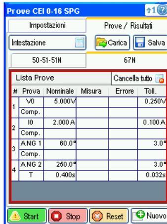
Lo strumento rappresenta i vari test su due righe, ma sulla riga indicata "Comp." Non si eseguono misure di tempo.
