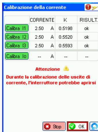
Premere OK: si ritorna allo schermo delle prove selezionate; lo strumento esegue la prova sulle fasi I1, I2 e I3 con le correnti calibrate e visualizza man mano i risultati.
